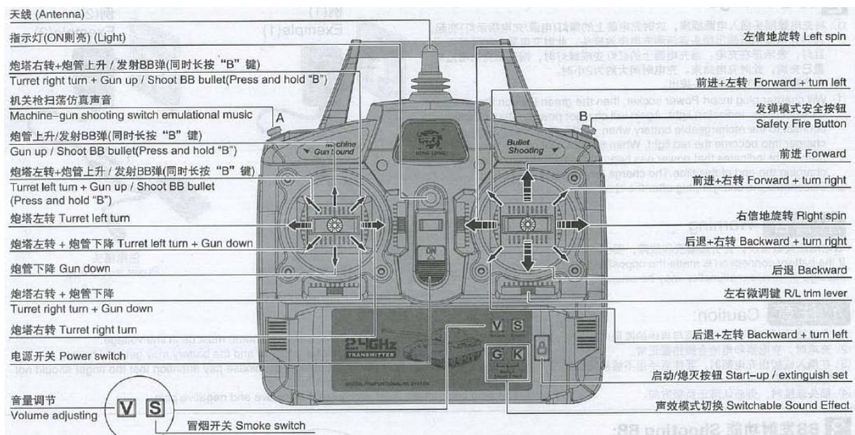
A noter qu'il existe désormais une protection sur la fonction tir du char. Il faut désormais presser le bouton B de la radiocommande et pousser le manche de gauche vers le haut afin d'activer le tir.
